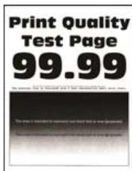
**Nota:** Antes de resolver el problema, imprima las páginas de muestra de calidad para determinar el color que falta. En la pantalla de inicio, toque **Valores > Solución de problemas > Páginas de prueba de la calidad de impresión.**
