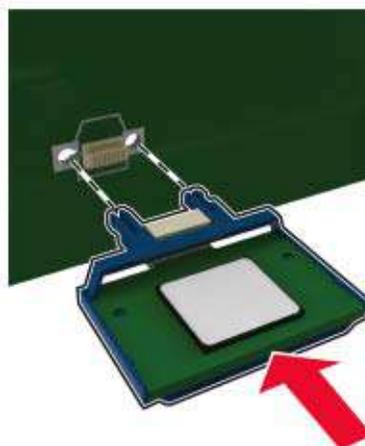
**Nota:** Todo el conector de la tarjeta debe tocar y estar nivelado con la placa del controlador.
